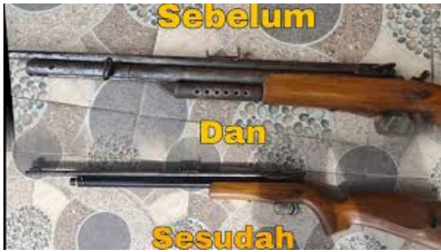
Gambar1. Senapan Uklik yang dimodifikasi menjadi senapan PCP
